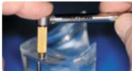
Se puede utilizar cualquier llave dinamométrica de paso cuadrado de 4.0 mm.
